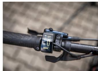
Die Display-Bedieneinheit-Kombination ist kompakt und gut zu bedienen. Leider geizt das integrierte Display mit Informationen und ist zudem bei direkter Sonneneinstrahlung schwierig oder überhaupt nicht ablesbar.
