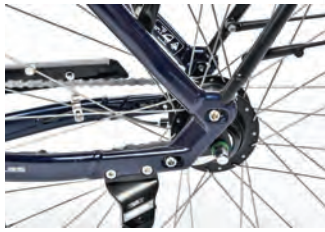
Stabil: Der Träger stützt sich großflächig über den Rahmen ab.
