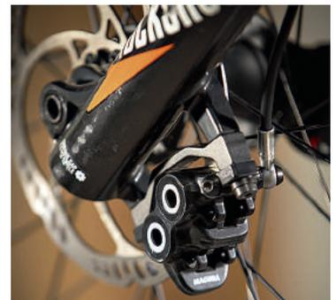
Bissig und standfest – damit überzeugt die Vierkolben-Vorderrad-Bremse MT5 von Magura. Perfekt für E-Bikes!
