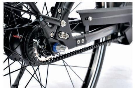
Ein wartungs- und ölfreier Gates-Riemen verbindet Antrieb und Nabenschaltung
