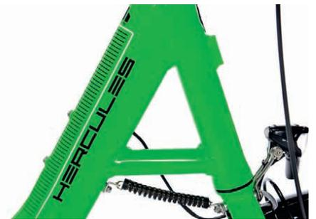
Kleines Detail, aber effektiv: Die Spiralfeder hält das Vorderrad beim Falten gerade.
