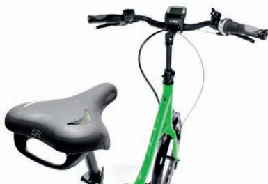
Griffmöglichkeiten am Sattel und oberhalb des Motors erleichtern das Tragen.
