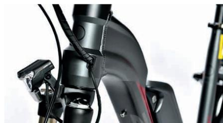
**Premium: solide Rahmen-Steuerrohrkonstruktion, innengeführte Züge.**
