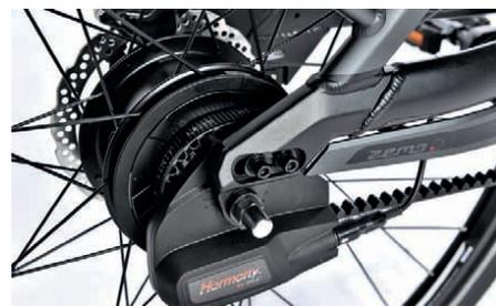
Die Automatikschaltung der NuVinci arbeitet überragend, Riemen an Bord.
