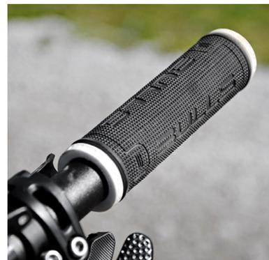
Einer der wenigen Kritikpunkte am Bulls: Mangels Schraubklemmung verdrehen sich die einfachen Gummigriffe ständig.
