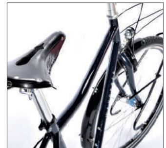
Der leichte Knick im Oberrohr bringt Schrittfreiheit.
